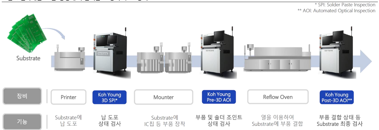
그림6. 전자제품 조립 공정에 투입되는 고영의 주요 장비
