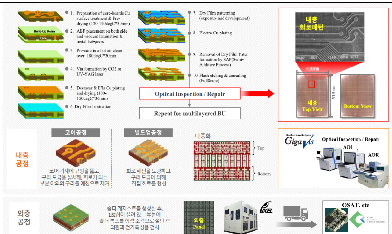
그림32. 반도체 기판 내층 공정 검사 및 수리 장비 개요
