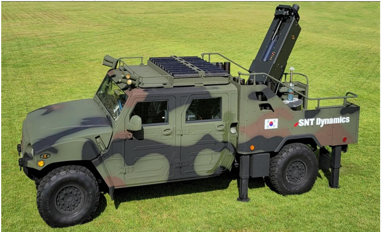
그림9. SNT 다이내믹스 소형전술차량(LTV) 탑재형 120mm 박격포체계
