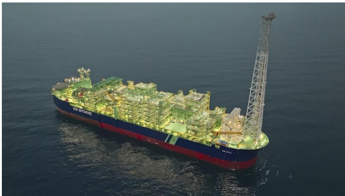
도표 5. 수심을 고려해 지어진 FPSO 생산설비 BW OPAL. 천연가스/컨덴세이트/물을 분리한 뒤 천연가스를 1차 처리하는 설비
