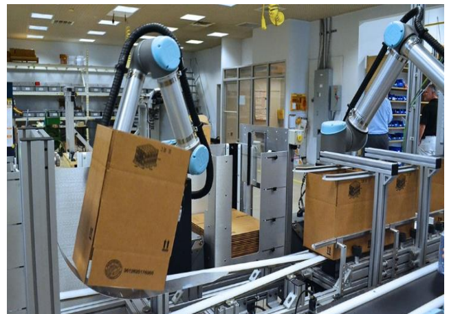
그림 12. 케이스 이렉터 (Case Erector) - 상자 조립 및 테이핑
