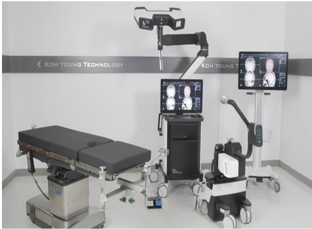
그림 1. 고영의 뇌수술 보조 로봇, Geniant Cranial
