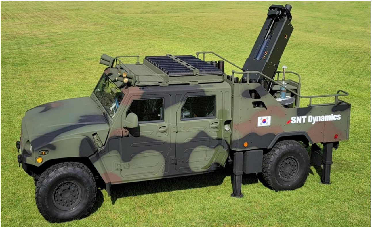
그림7. SNT 다이내믹스 소형전술차량(LTV) 탑재형 120mm 박격포체계
