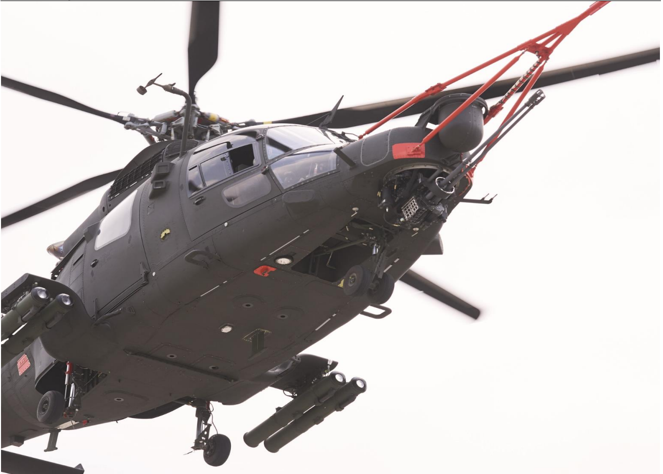
그림8. LAH(Light Armed Helicopter)에 부착된 터렛형 기관총 시스템(TGS)
