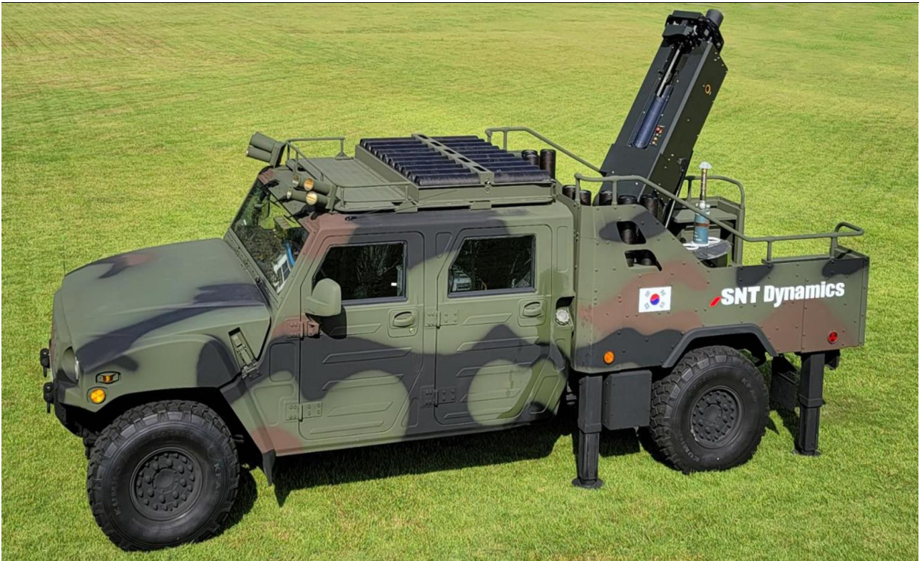
그림7. SNT다이내믹스 소형전술차량(LTV) 탑재형 120mm 박격포체계
