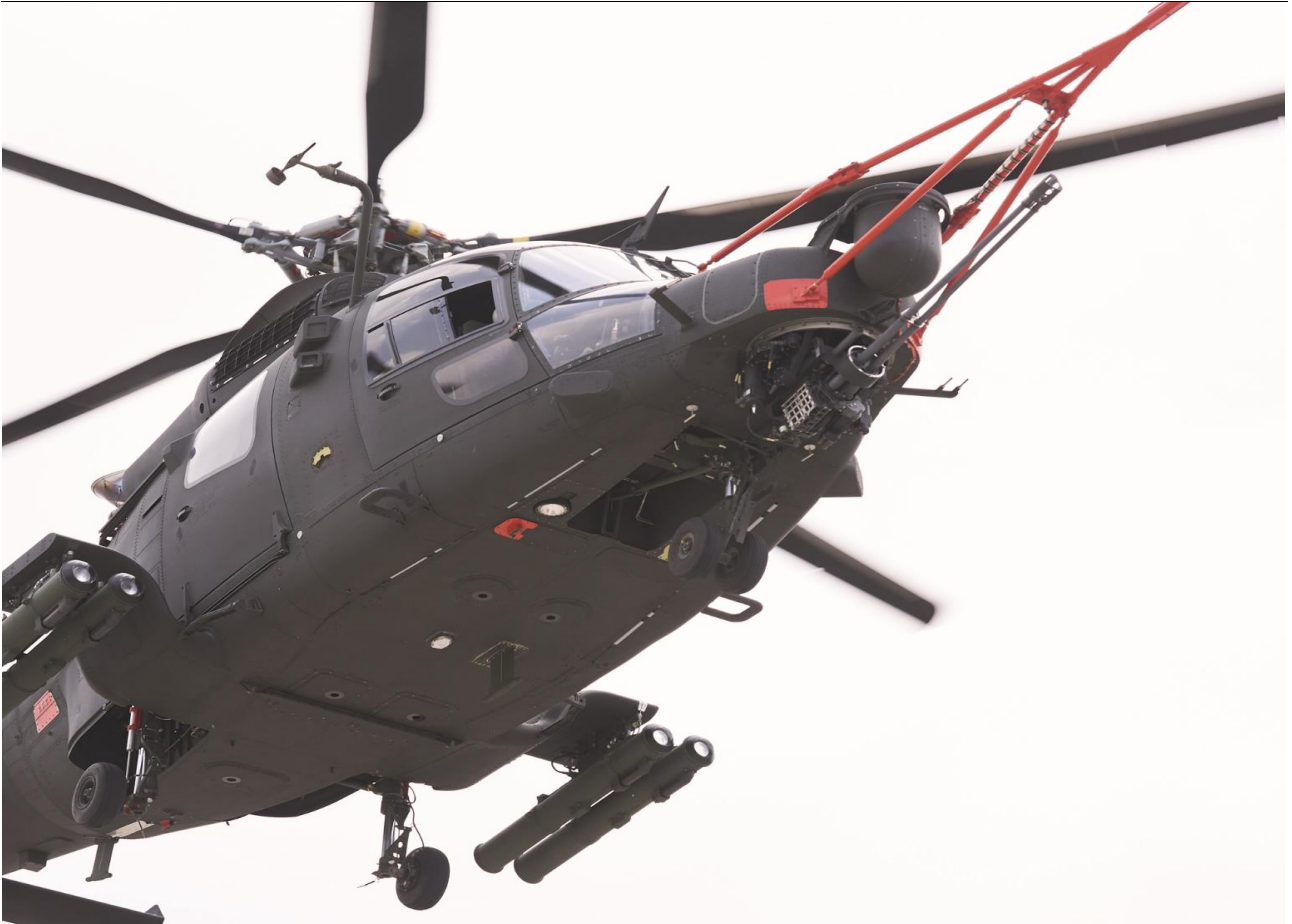
그림8. LAH(Light Armed Helicopter)에 부착된 터렛형 기관총 시스템(TGS)
