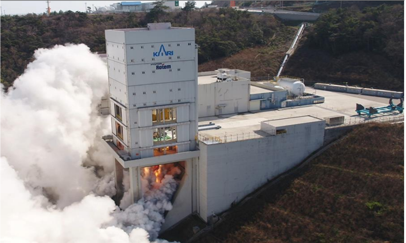
그림9. 현대로템이 구축한 한국형발사체 추진기관시스템 시험설비
