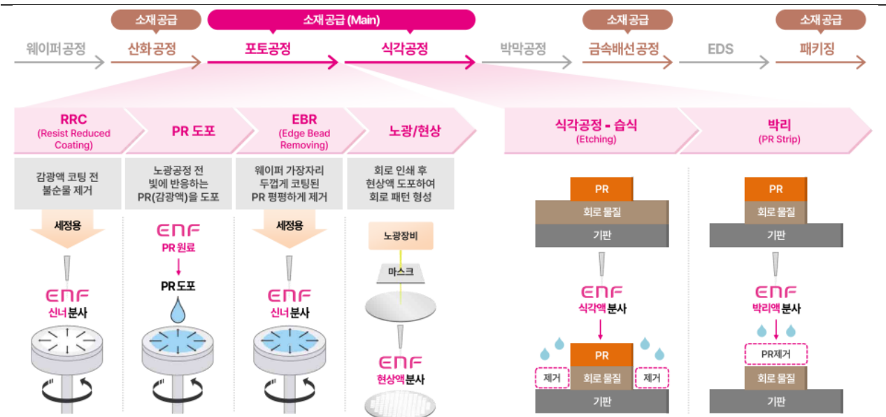
그림 15. 반도체 제조공정별 이엔에프테크놀로지 제품 적용 영역
