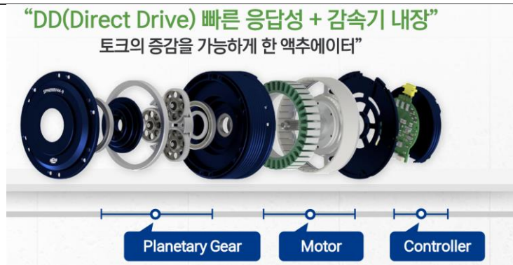
그림 7. SDD(SPG Direct Drive)
