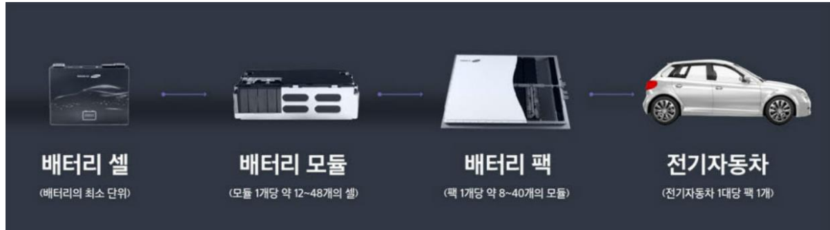
[도표 5] 배터리 셀, 모듈, 팩 구조
