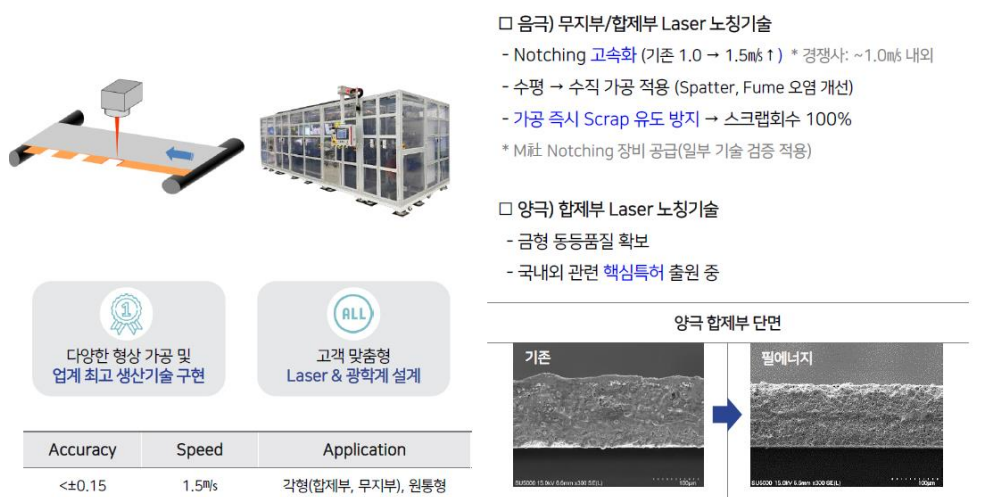
그림 6. 음극 및 양극 유지부 레이저 노칭 개발 완료
