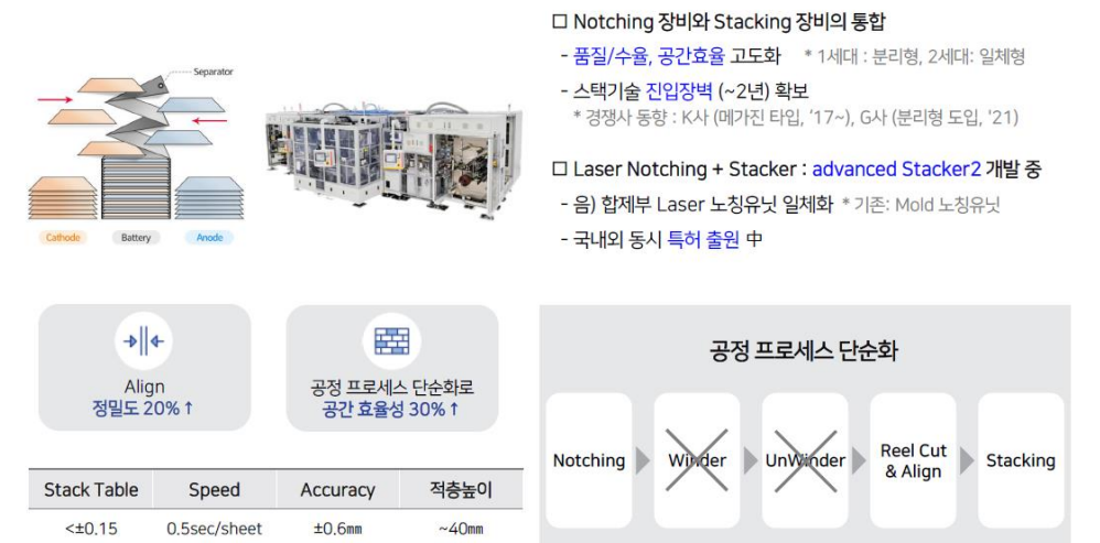
그림 5. Advanced 스태킹 장비 개발. Techtime 감소 및 공간 효율 개선
