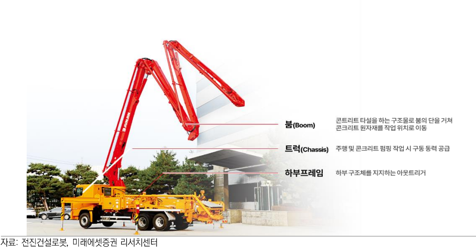
그림 5. 콘크리트 펌프카(CPC) 구성요소
