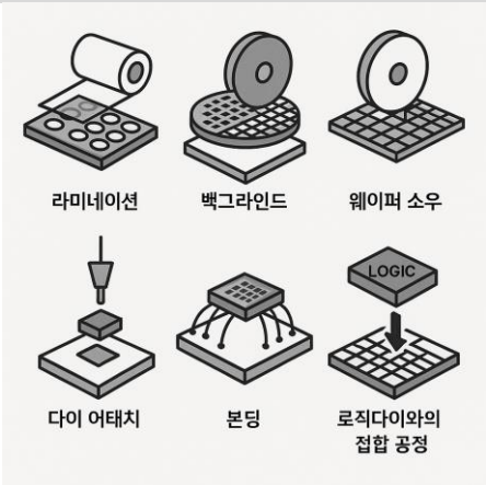
그림 5. HBM 용 반도체 후공정의 과정
