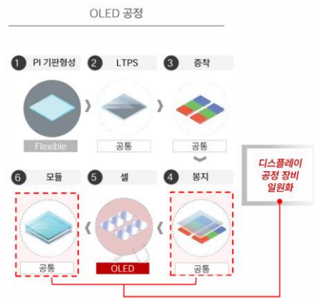
그림 9. 모듈과 봉지 공정에서의 일원화가 이루어지고 있는 OLED 공정
