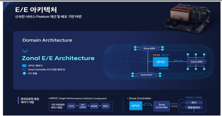
[그림5] 현대차 Zonal E/E 아키텍처(HPVC 기반 중앙 집중화로 제어 구조 간소화)
