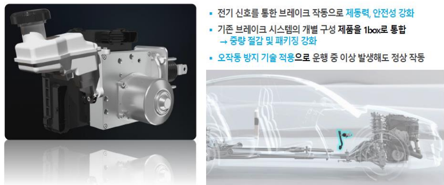
[그림12] IDB(Integrated Dynamic Brake): ABS/ESC와 마스터실린더를 액추에이터 기반 전자화 통합 : 25년 멕시코공장 100만대 규모 양산/공급, 북미향 매출 증가 전망
