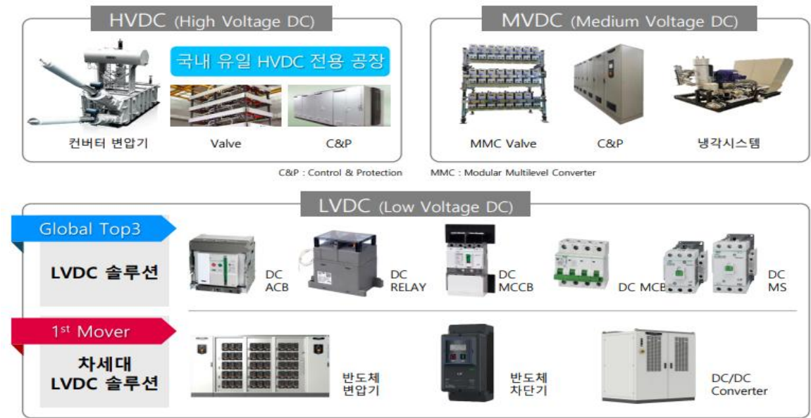
그림 14. LS ELECTRIC의 DC(직류) 솔루션
