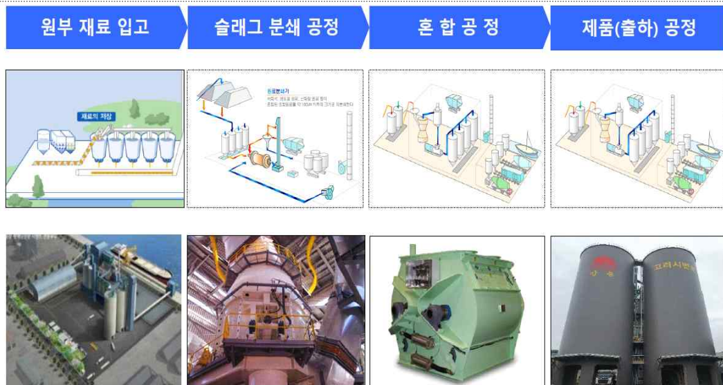
그림 6. 고로슬래그 시멘트 제조 공정
