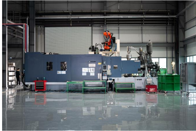
그림 7. KH바텍 하노이 전자용 Thixo 공법 생산라인
