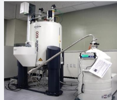
NMR 600Mhz-Prodigy (Nuclear Magnetic Resonance) 고분자구조 분석장비
